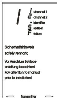
**Fig. 5.1-1:** Indicadores de funcionamiento del emisor
