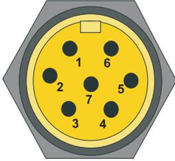
**Bild 7.4-2:** Maschinen-Interface /T3, MIN-Series (Blick auf die Stifte)
