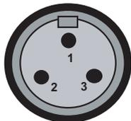
**Bild 7.4-1:** Sender-Interface /T3, MIN-Series Stecker (Blick auf die Stifte)
