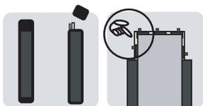
**Bild 4.3-5:** Zuschalten der Einlernmöglichkeit für „Bewegliche Ausblendung“ mit S4/S5
