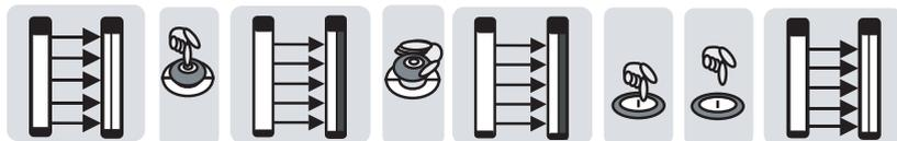
**Bild 4.2-4:** Bereichs-NOT-AUS bedingt die Anlauf-/Wiederanlaufsperr Funktion
