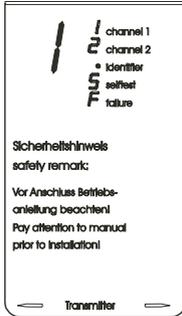
**Bild 5.1-1:** Betriebsanzeigen Sender
