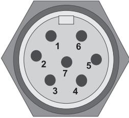
**Bild 7.4-2:** Empfänger Maschinen-Interface /T3, MIN-Series (Blick auf die Stifte)
