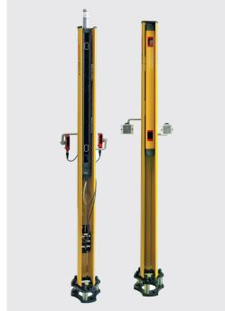
CPSET-M27 und -M28 sind Muting-Komplettsysteme für Zugangssicherungen, durch die betriebs-bedingt Material transportiert werden muss. Neben der optischen Schutzeinrichtung mit integriertem LED-Mutingleuchtmelder enthalten die CPSET zwei Gerätesäulen, in denen die Geräte so vormontiert werden, dass sie einfach in der Höhen verstellbar sind. Muting wird durch zwei unabhängige Signale gesteuert, die gleichzeitig innerhalb von 3,5 s aktiviert werden müssen:
