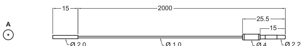
A Ø 0,25 mm noyau de la fibre x 1 pièce
