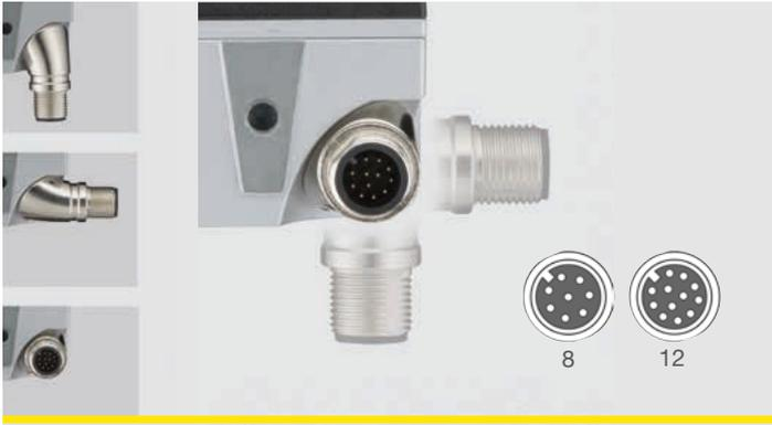
Mit seinem drehbaren Anschluss bietet der RSL 200 maximale Flexibilität bei der Kabelführung. Alle Funktionen des Gerätes lassen sich über den Standard-M12-Anschluss in 8-poliger Ausführung steuern und auswerten (12-polig bei RSL 230/235). Das bedeutet geringen Platzbedarf und wenig Aufwand bei der Integration und der Inbetriebnahme.
