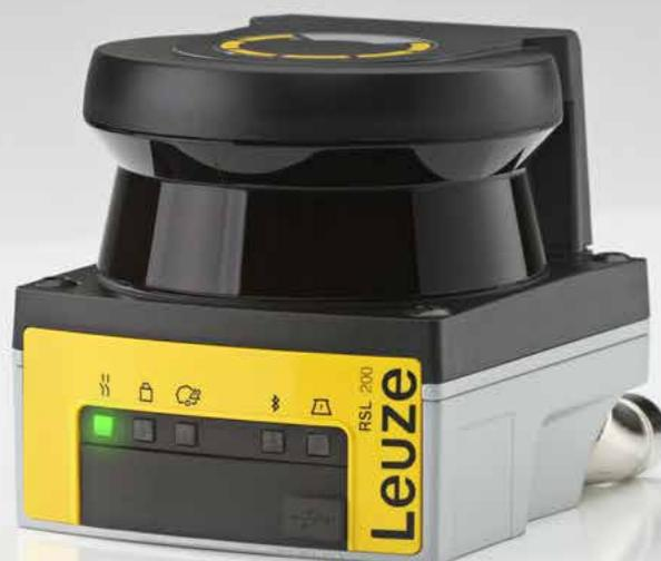
Die kompakten Sicherheits-Laserscanner RSL 200 benötigen mit ihren Abmessungen von 80 x 80 x 86 mm nur wenig Platz und lassen sich so einfach und unauffällig in das Maschinendesign integrieren. Mit 3,00 m Reichweite und 275° Scanwinkel bieten sie kostengünstige Lösungen für viele Standard-Aufgaben zur Bereichssicherung.
