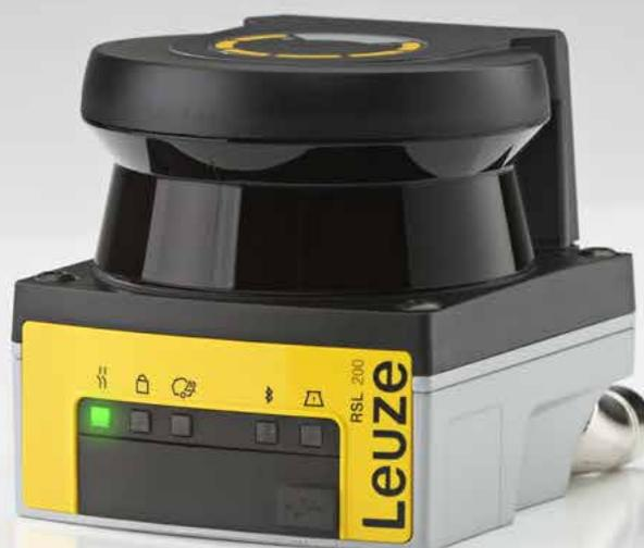
Die kompakten Sicherheits-Laserscanner RSL 200 benötigen mit ihren Abmessungen von 80 x 80 x 86 mm nur wenig Platz und lassen sich so auch in kleine FTS und AMR perfekt integrieren. Mit 275° Scanwinkel sichern zwei Scanner ein Fahrzeug rundum ab.
