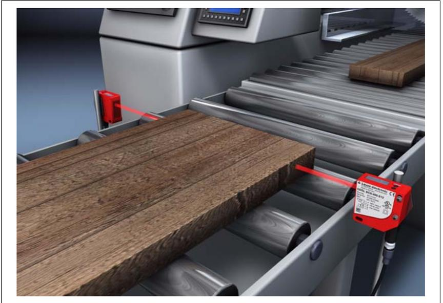
그림 4.2: 사용 예시 : ODSL 9를 이용한 목재 폭 측정
