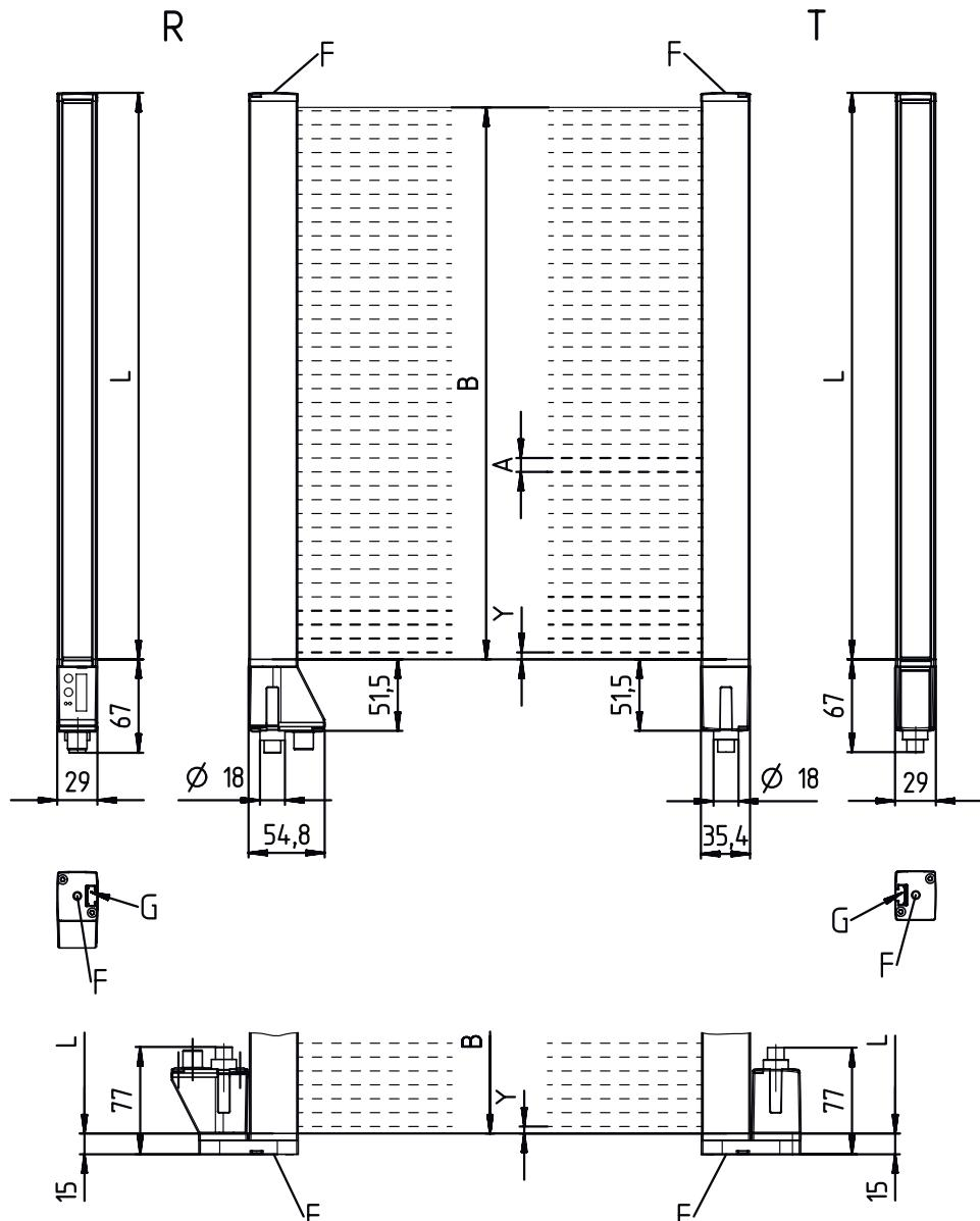
A Intervalle entre les faisceaux 40 mm
