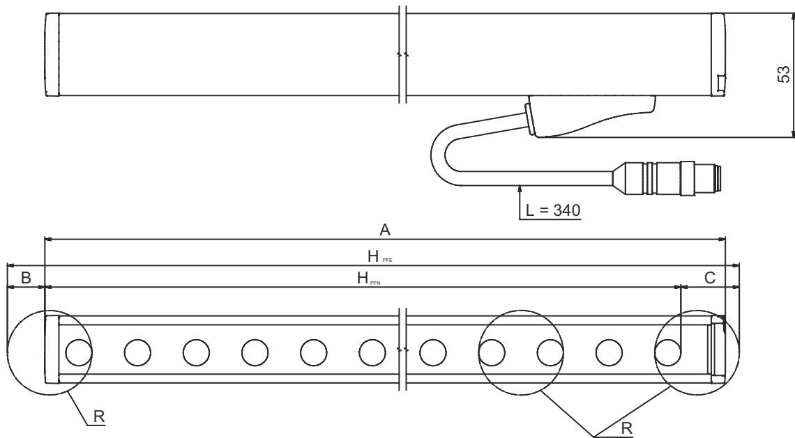
$H_{PFE}$  有效保护区域高度 = 917 mm $H_{PFN}$  标称保护高度 = 900 mm
