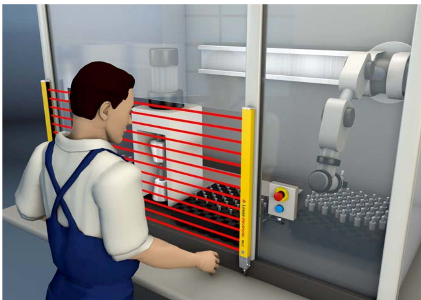
Fig. 5.2: Les sécurisations de postes dangereux offrent une protection lors de l'intrusion dans une zone dangereuse, par exemple pour une application robotisée Pick & Place
