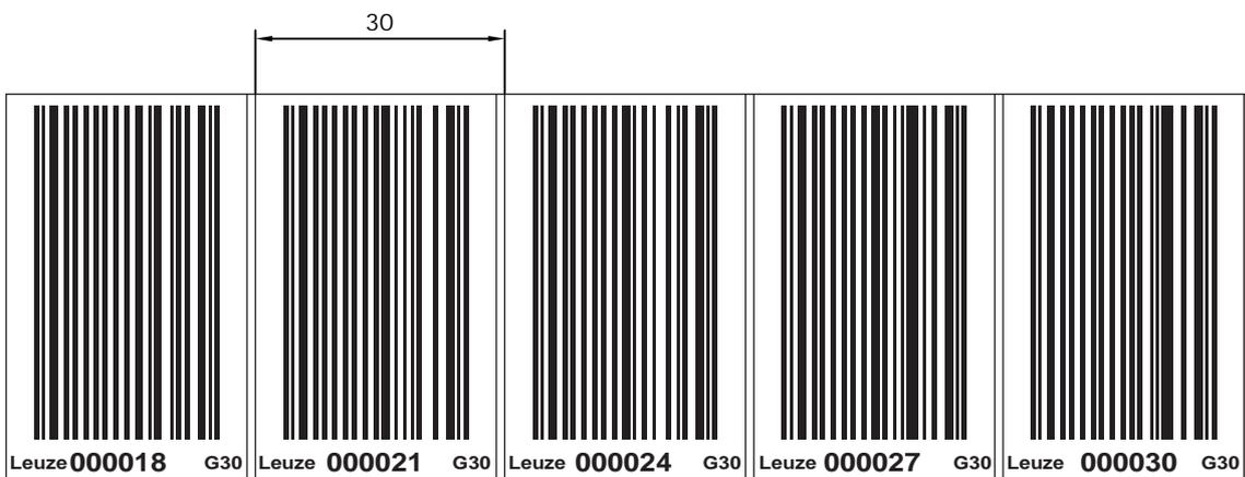
Bild 12.2: Überprüfen des Druckergebnisses BCB G30 ...-Reparaturkit (30 mm Raster)
