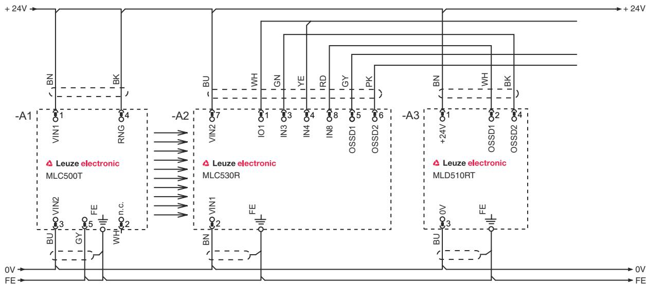
Modo operativo 3: esempio di circuito di un interruttore di posizione concatenato a contatto per il monitoraggio di oggetti oscurati ed un commutatore per la commutazione tra i gruppi di funzioni FG1 e FG2
