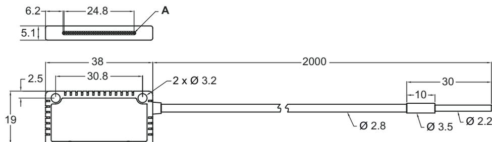
A Ø 0,265 mm noyau de la fibre de verre x 32 pièces
