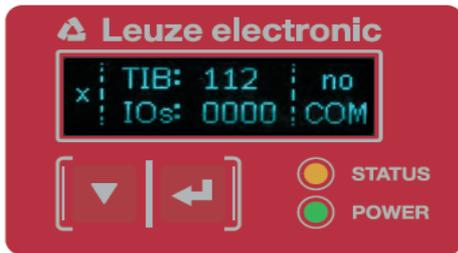
Ilustração 3.4: Display OLED no receptor
