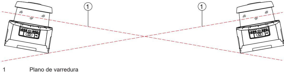
Fig. 7.10: Montagem adjacente, sem desfaseamento vertical, alinhamento cruzado
