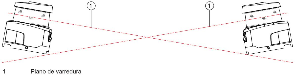
Fig. 7.11: Montagem oposta, sem desfaseamento vertical, alinhamento cruzado
