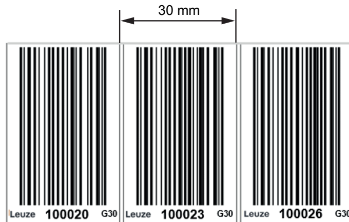
Fig. 9.12: Verificar a dimensão de 30 mm na fita de códigos de barras de reparo online autoimpressa
