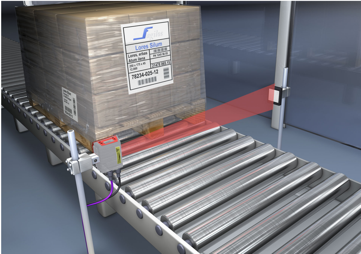
Figura 4.2: Disposizione del riflettore per autoReflAct
