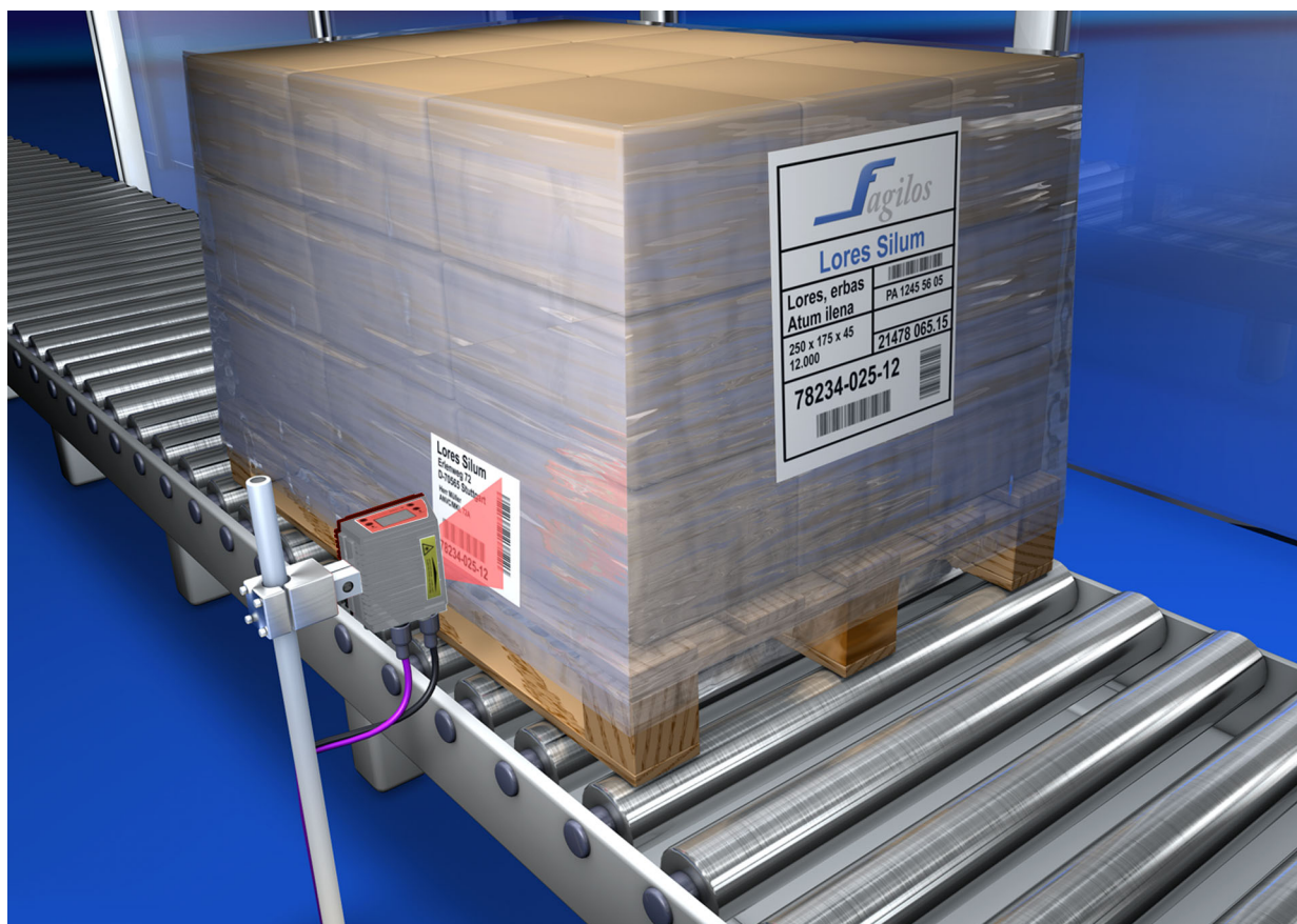
Figura 5.1: Principio di deflessione per lo scanner a linee
