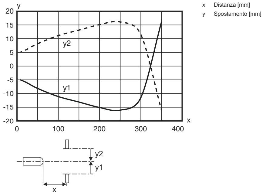
Comportamento di risposta tip. (distanza di regolazione 600 mm)
