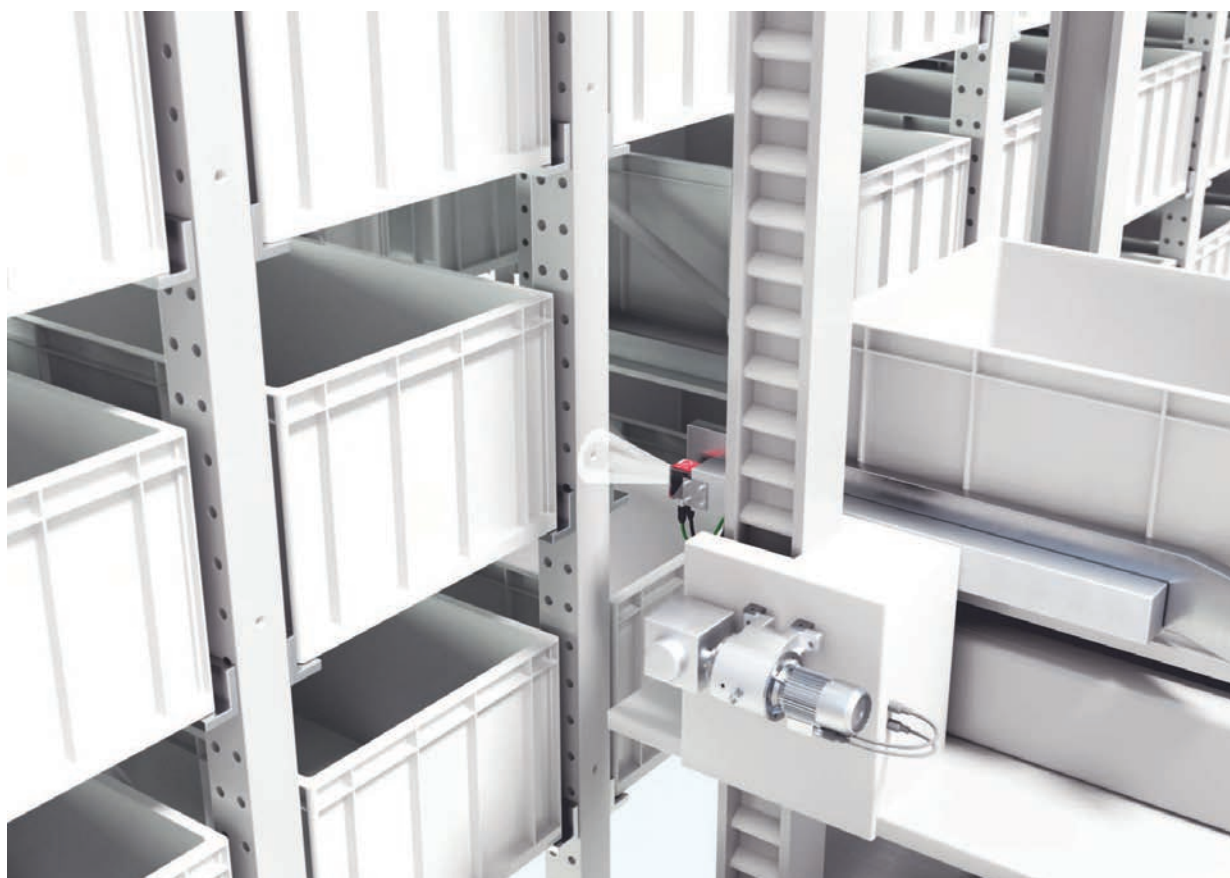
Fig. 5.2: Positionnement précis dans les racks dans un entrepôt de stockage de conteneurs de petites pièces
