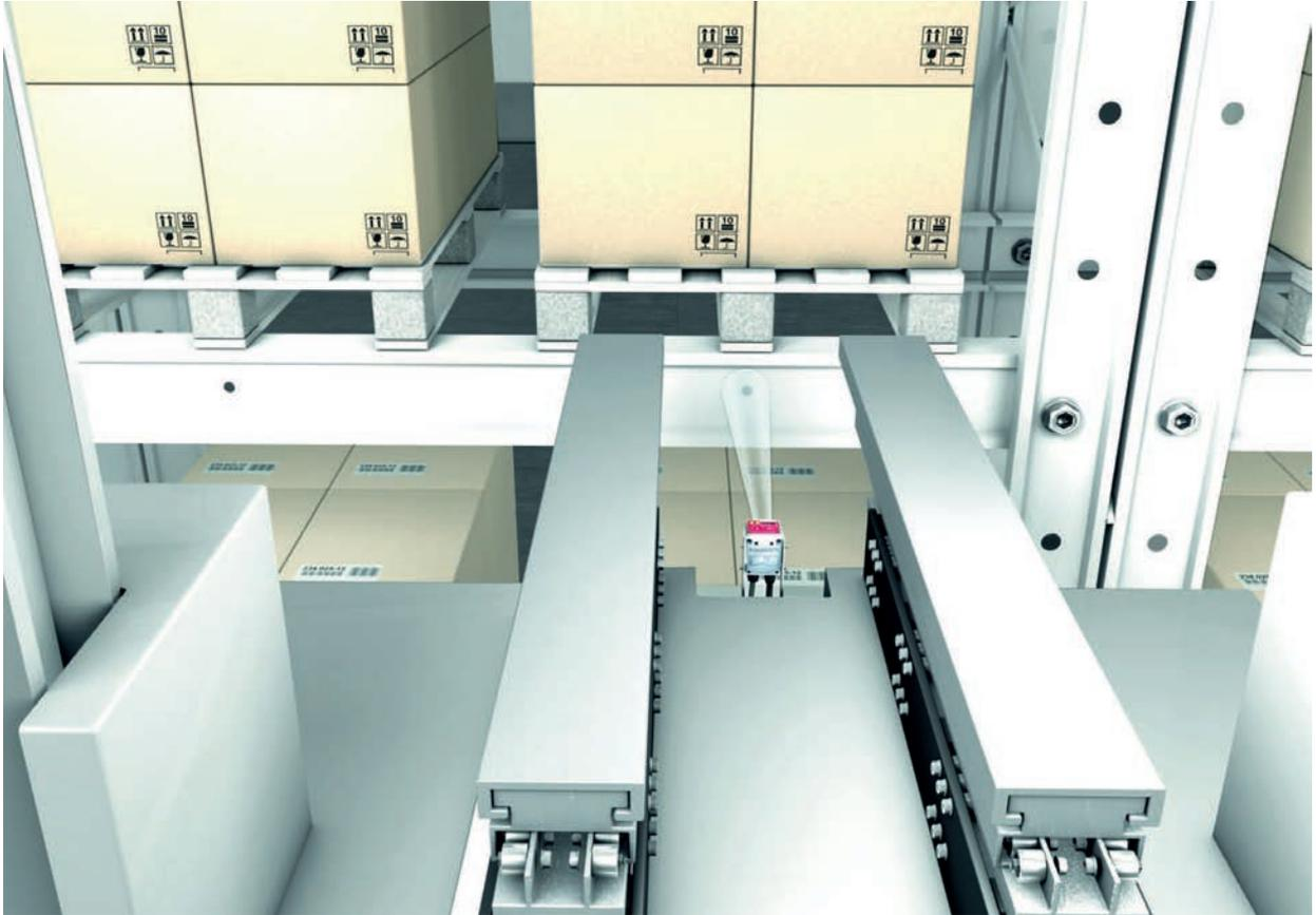
Bild 5.1: Fachfeinpositionierung eines Regalbediengeräts im einfach tiefen Paletten-Hochregallager
