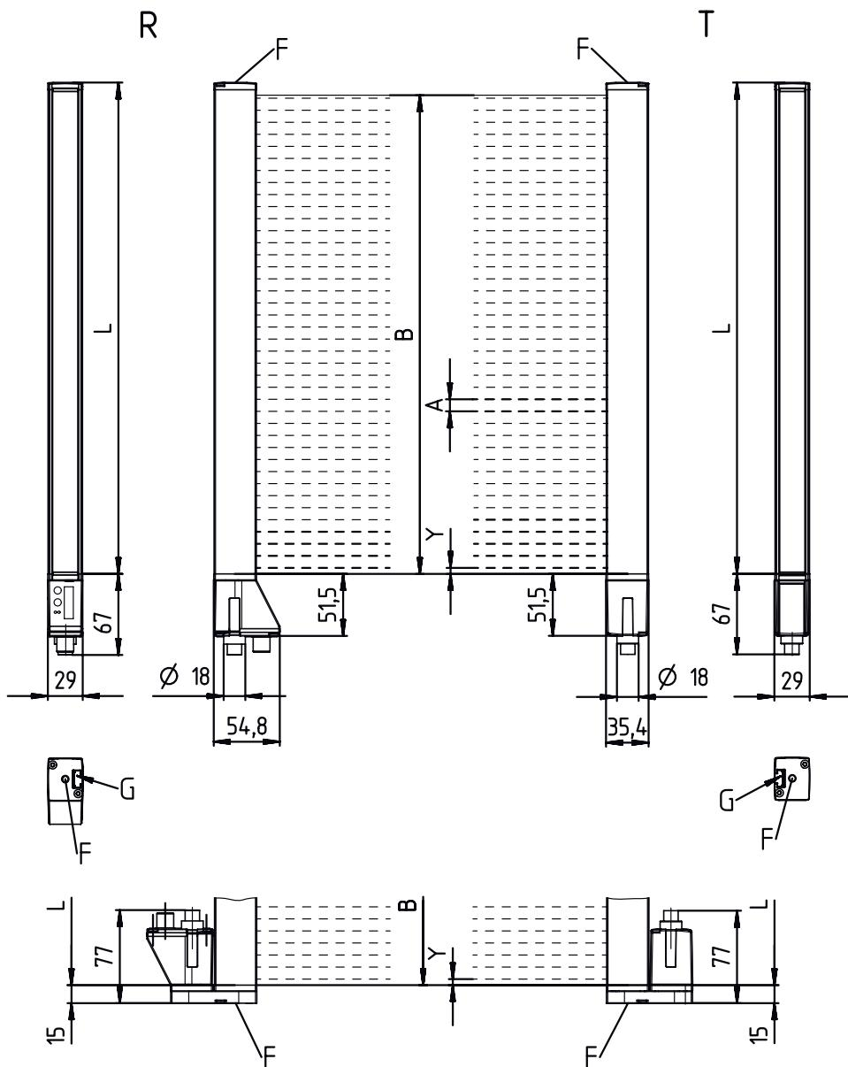
A 光束距离 5 mm      L 型材长度 1368 mm
