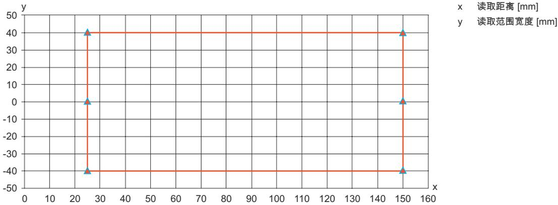
模块的阅读曲线  $m = 0.2 \dots 0.5 \text{ mm}$  (8 ... 20mil)
