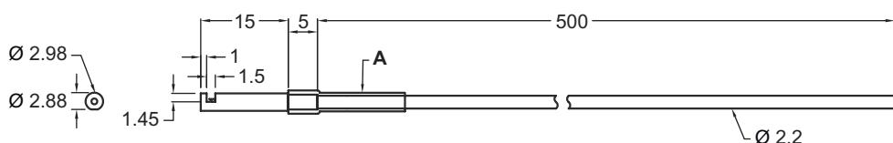
A Schutzschlauch Ø 3,5
