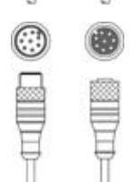
3 | 50135146       | KDS S-M12-8A-M12-<br>8A-P1-050  | Câble de liaison                      | Application: Résistant à l'huile/aux lubrifiants<br>Connexion 1: Connecteur rond, M12, Axiale, Prise femelle, Codage A, 8 pôles<br>Connexion 2: Connecteur rond, M12, Axiale, Prise mâle, Codage A, 8 pôles<br>Blindé: Oui<br>Longueur de câble: 5.000 mm<br>Matériau de gaine: PUR                                                                |
