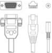
50114517 | KB 232-1 IT190x | 互连电缆 | 适合接口: RS 232, TTL<br>连接1: RJ41<br>连接2: Sub-D, 直形, 插座, 9 个引脚<br>连接3: 接头, 可插拔式, 直形, 插座, 2 个引脚<br>有屏蔽: 是<br>电缆长度: 3,000 mm<br>护套材料: PVC |
