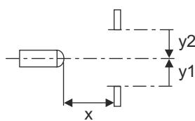
Comportamento di risposta tip. con 90% di remissione (distanza di regolazione 400 mm)
