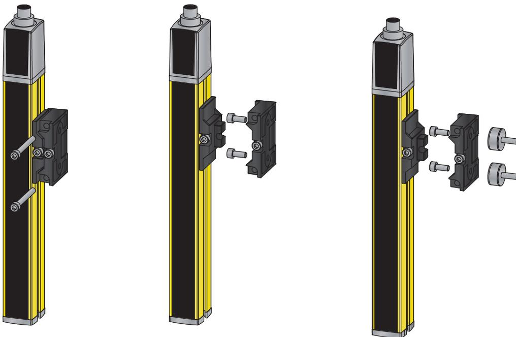
图 7.9: 通过可转动支架 BT-2SB10 安装
