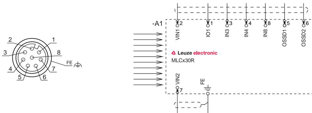
图 8.3: 接收器的插头分配和接线图
