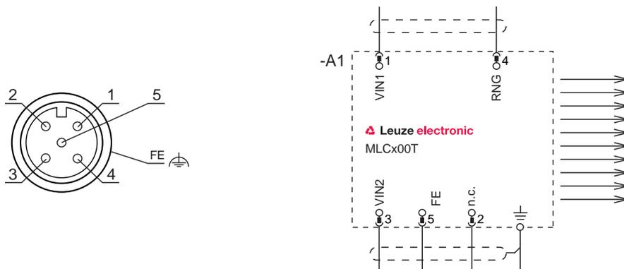
图 8.1: 发射器的插头分配和接线图
