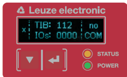
Bild 3.7: Funktionstasten am Empfänger
