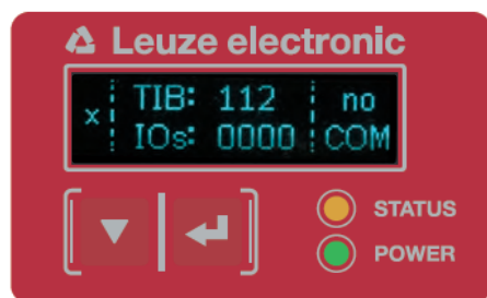
Bild 8.3: Displaydarstellung des Prozessbetriebszustands des Lichtvorhangs
