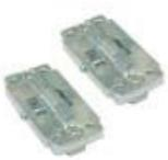
6    | 424417   | BT-2P40                         | Set de soportes                  | Orificio 1: M6<br>Orificio 2: M6<br>Versión de la pieza de fijación: Soporte presor<br>Fijación, lado de la instalación: Montaje en ranura<br>Fijación, del lado del equipo: Montaje en ranura<br>Tipo de pieza de fijación: Puede unirse por apriete, Apto para montaje en columnas de montaje UDC-S2, DC-S2<br>Material: Metal |
