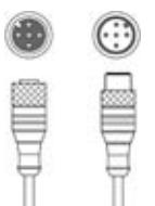
3 | 50129781 | KDS DN-M12-5A-<br>M12-5A-P3-050 | Cable de interconexión           | Apropiado para interfaz: DeviceNet, CANopen<br>Conexión 1: Conector redondo, M12, Axial, Conector hembra, Codificación A, 5 polos<br>Conexión 2: Conector redondo, M12, Axial, Conector macho, Codificación A, 5 polos<br>Apantallado: Sí<br>Longitud de cable: 5.000 mm<br>Material de cubierta: PUR                            |
