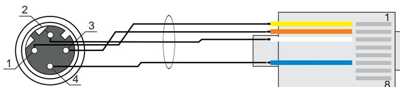
Bild 7.10: Leitungsbelegung HOST auf RJ-45
