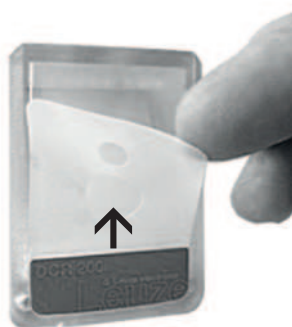
Figura 6.29: Applicazione del film diffusore
