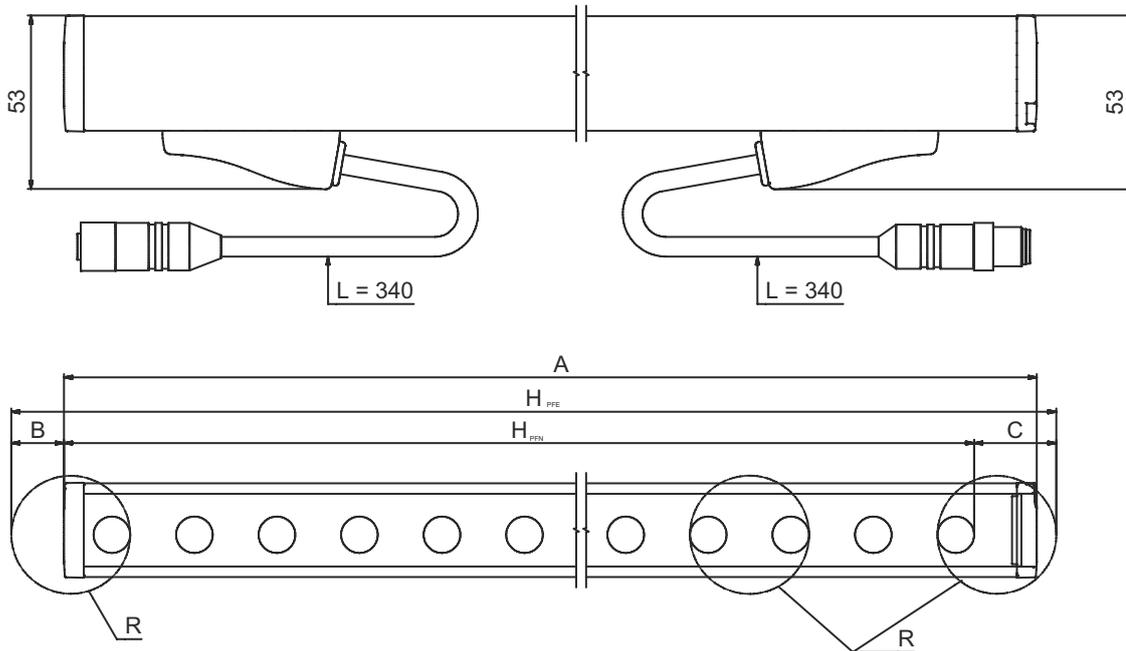
$H_{PFE}$  有效保护区域高度 = 1590 mm $H_{PFN}$  标称保护高度 = 1500 mm
