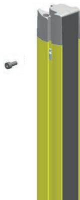
Figura 5.6: Montaggio via tasselli scorrevoli
