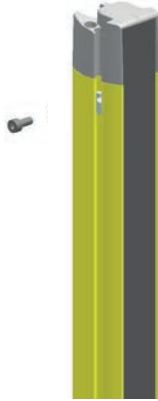
Fig. 5.6: Montage à l'aide d'écrous coulissants
