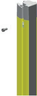
Bild 5.6: Montage über Nutensteine
