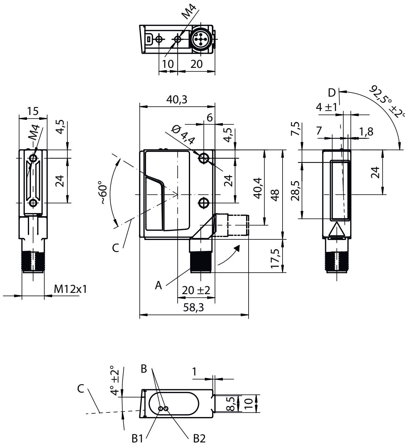
A Drehstecker, um 90° drehbar
