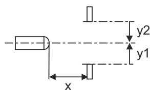
Réaction typ. (distance de réglage 500 mm)
