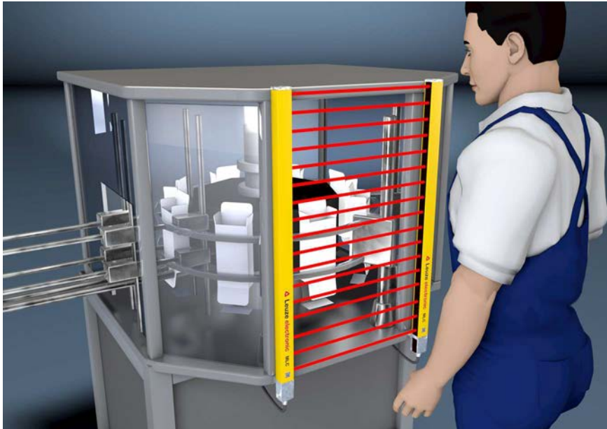
그림 5.1: 위험 지점 안전 장치는 예를 들어 포장 기계나 주입장치에서 위험 지역에 개입해야 하는 경우에 보호합니다
