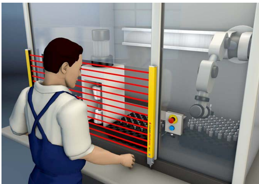
Figura 5.2: Le protezioni di punti pericolosi proteggono durante gli interventi nell'area pericolosa, ad es. presso un'applicazione robotizzata Pick & Place
