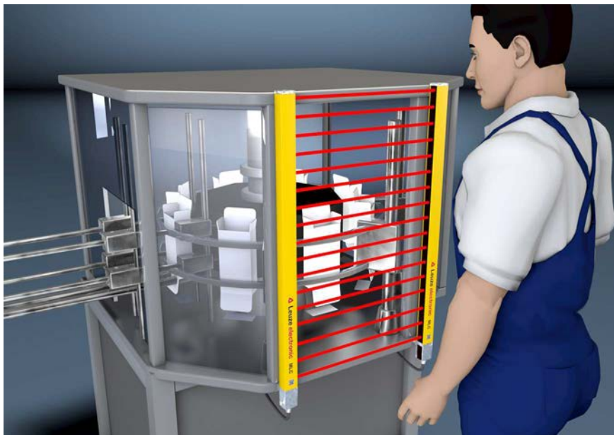
Figura 5.1: Le protezioni di punti pericolosi proteggono durante gli interventi nell'area pericolosa, ad es. presso un'incartatrice o impianti di imbottigliamento
