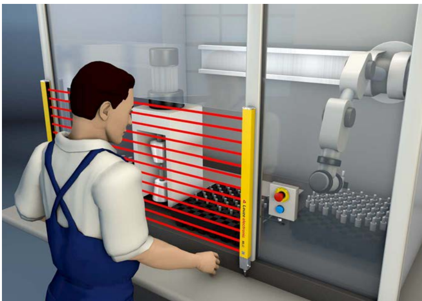
图 5.2: 安全传感器防止进入危险区域如取放机器人
