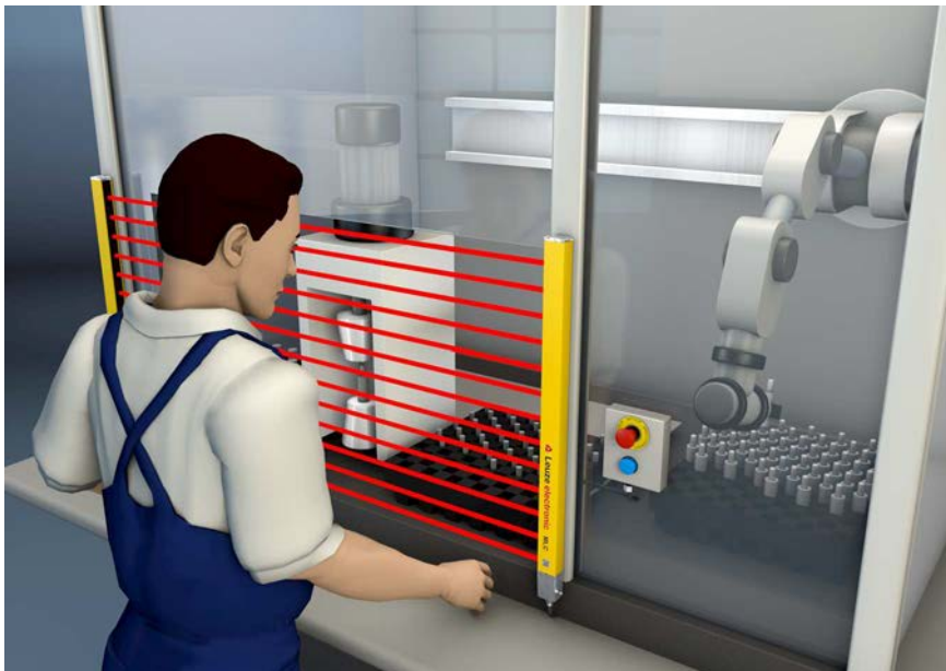
Bild 5.2: Gefahrstellensicherungen schützen beim Eingriff in den Gefahrenbereich, z. B. bei einer Pick & Place Roboterapplikation
