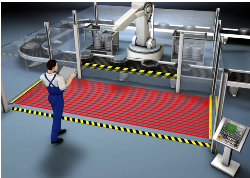
图 5.4: 用于机器人的危险区域防护
