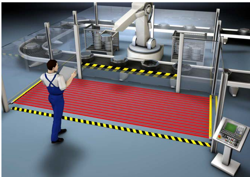
Bild 5.4: Gefahrbereichssicherung an einem Roboter
