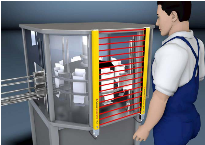
Bild 5.1: Gefahrstellensicherungen schützen beim Eingriff in den Gefahrenbereich, z. B. bei einem Kartonnier oder an Abfüllanlagen
