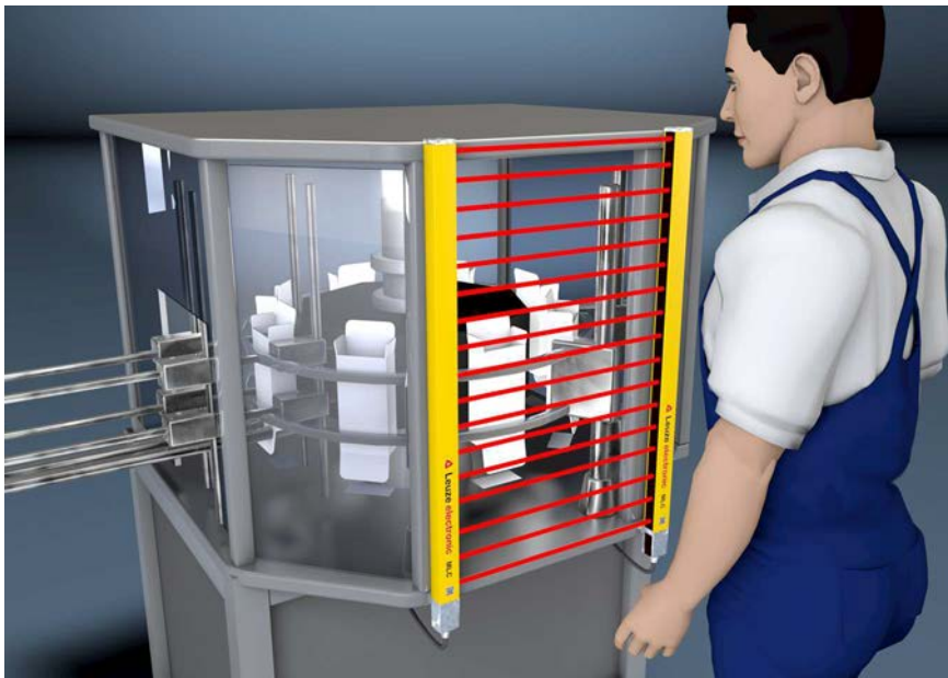
图 5.1: 安全传感器防止进入危险区域如装盒机或填充机
