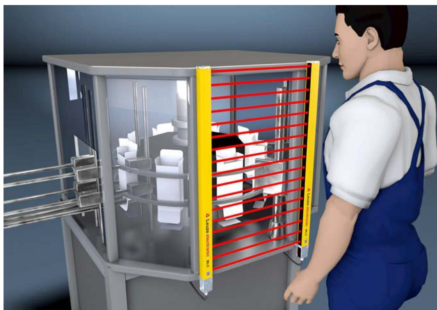
Fig. 5.1: Resgare as proteções de acesso a pontos de perigo ao intervir na zona de perigo, por exemplo, no caso de uma máquina de cartonagem e sistemas de enchimento
