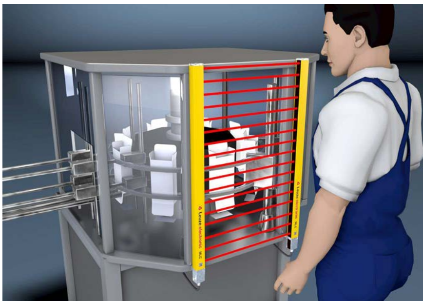
Figura 5.1: Las protecciones de puntos peligrosos protegen en caso de intervención en la zona de peligro, p. ej., en una encartonadora o instalaciones de envasado
