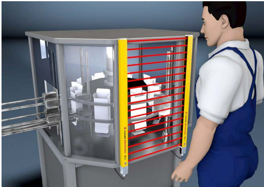
Bild 5.1: Gefahrstellensicherungen schützen beim Eingriff in den Gefahrenbereich, z. B. bei einem Kartonierer oder an Abfüllanlagen
