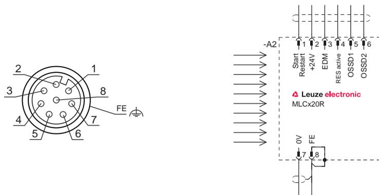
Bild 7.4: Steckerbelegung und Anschlussbild Empfänger
