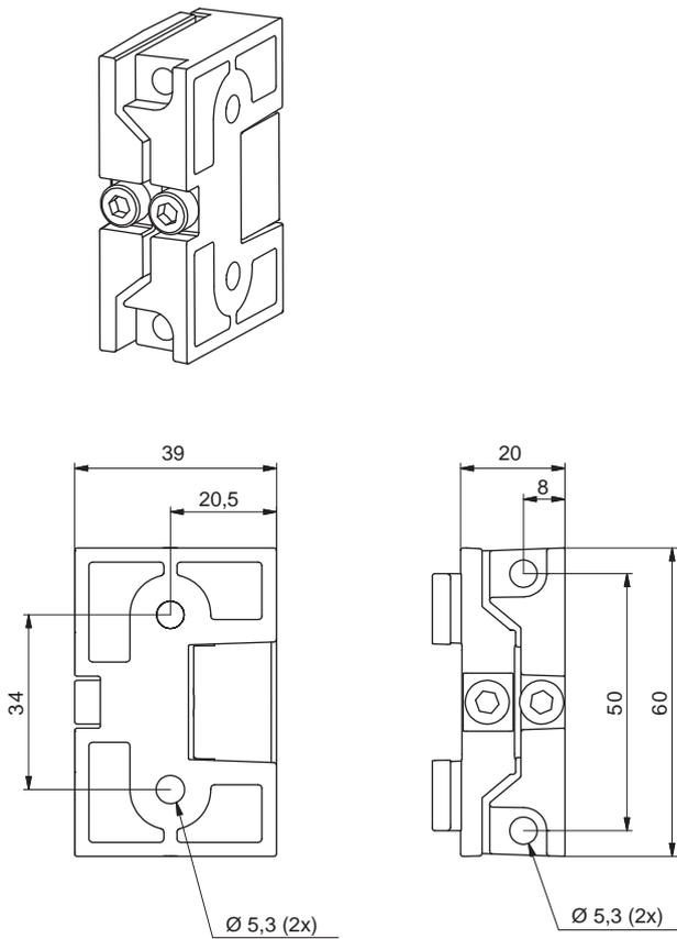
Bild 14.6: Schwenkhalterung BT-2SB10
