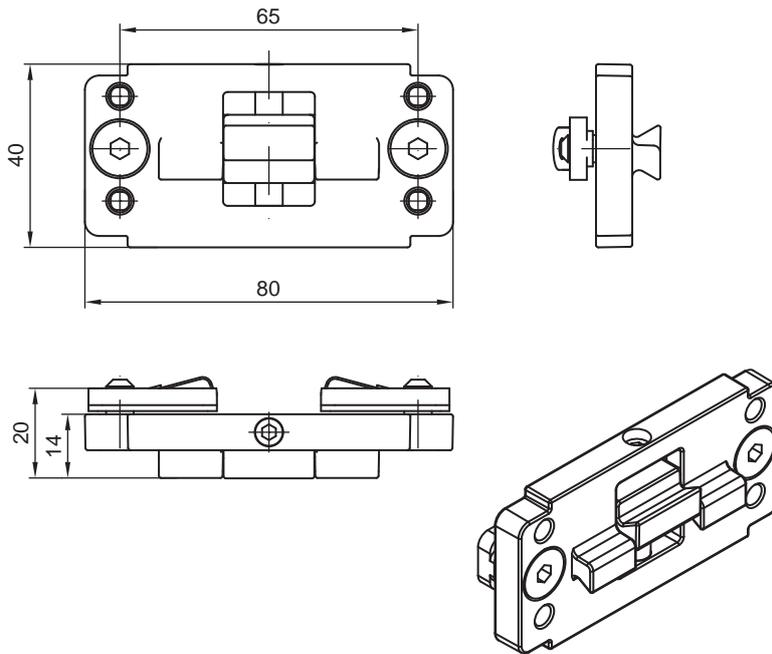
Bild 14.5: Klemmhalterung BT-P40 zur Befestigung in UDC-Gerätesäulen
