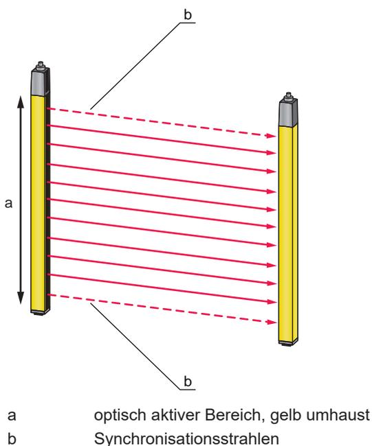
Bild 3.1: Sender-Empfänger-System
