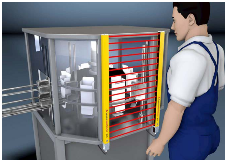
Fig. 5.1: Les sécurisations de postes dangereux offrent une protection lors de l'intrusion dans une zone dangereuse, par exemple pour des cartonneuses ou des installations de remplissage
